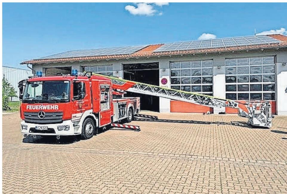
Die Leiter kann bis zu 30 Meter ausgefahren werden, der oberste Teil ist abknickbar.
